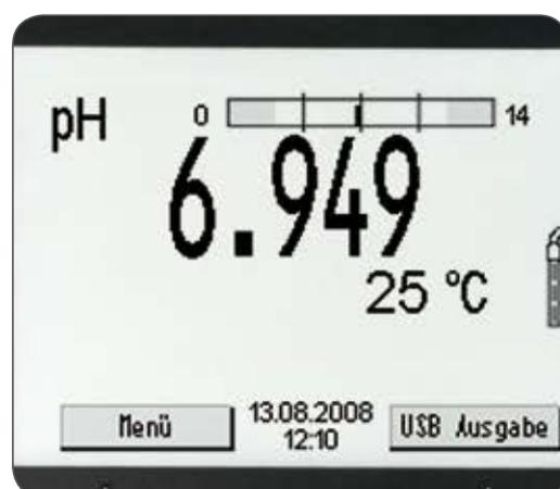
Die CMC-Funktion (Continuous Measurement Control) zeigt beim pH 3310 kontinuierlich an, ob man sich im kalibrierten Bereich befindet, und warnt bei Überschreitung
