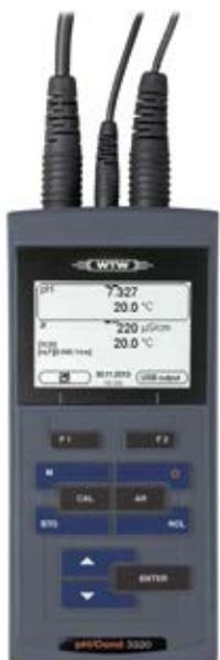
Das pH/Cond 3320 besitzt ein robustes, wasserdichtes Gehäuse (IP67) und verfügt über einen Speicher sowie einen Datenlogger mit einem einstellbaren Intervall zwischen 1 s und 60 Minuten. Alle Einträge enthalten GLP unterstützend Datum, Uhrzeit sowie die manuell eingebbare ID-Nummer. Die moderne, wasserdichte USB-Schnittstelle dient zur einfachen und schnellen Datenübertragung.
