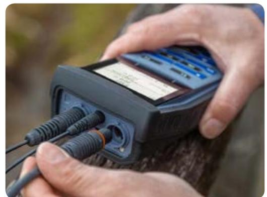
Mit wasserdichter Mini USB-B Schnittstelle zur modernen Datenübertragung
