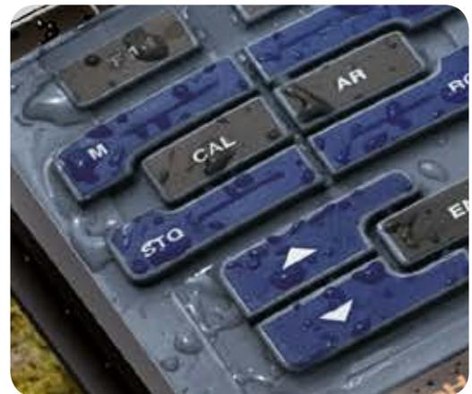
Robuste Silikontastatur mit geschlossener Oberfläche - 100% wasserdicht
