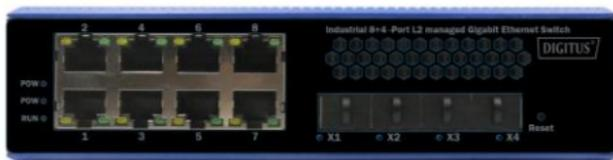
**Frontplatte:** das gelbe Licht am RJ45-Port ist das Link-Licht, es leuchtet, wenn die Verbindung hergestellt ist, und die Übertragungsdaten blinken; das grüne Licht am RJ45-Port ist das POE-Licht, das nur dann leuchtet, wenn der Switch-Port die Downlink-PD mit Strom versorgt; die grüne LED leuchtet für den Systembetrieb. Die Stromanzeige "POW" zeigt an, ob das aktuelle Gerät normal mit Strom versorgt wird. Die grüne LED für die optische Verbindung
