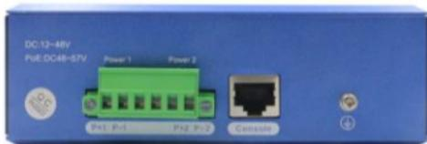
**Seitenwand:** P1 und P2 sind die Anzahl der Anschlussklemmen, P+1 und P-1 stehen jeweils für die anzuschließenden Plus- und Minuspole; Erdungsschraube, die für die Erdung der Ausrüstung verwendet wird.
