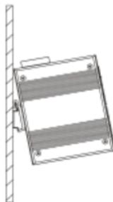
die Führungsschiene und der Schalter vertikal und stabil auf der Führungsschiene befestigt sind.
