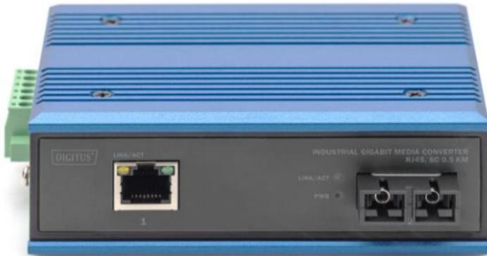
**Frontplatte:** Die gelbe LED am RJ45-Port ist die LINK-Leuchte, die leuchtet, wenn die Verbindung hergestellt ist und die Datenübertragung blinkt. Das grüne Licht am RJ45-Port ist das PoE-Licht, das nur leuchtet, wenn der Switch-Port die PD-Geräte mit Strom versorgt (**nur PoE DN-652104-1**)
