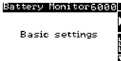
Drücken Sie danach SET um in das Menü einzusteigen. Mit der Taste "Pfeil nach unten" navigieren Sie bis zum Parameter "Batteriekapazität".
