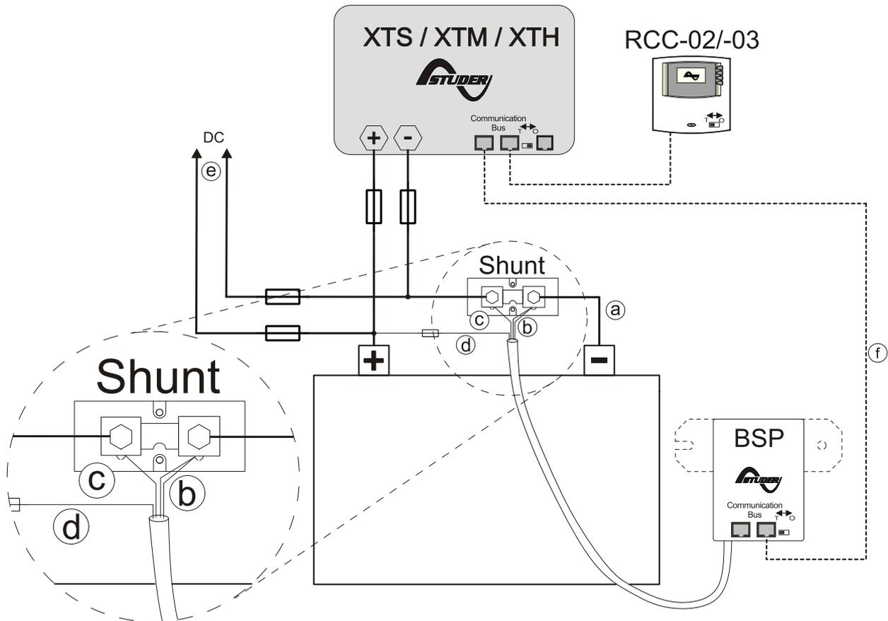
Abbildung 4.1. Anschlussschema des BSP
