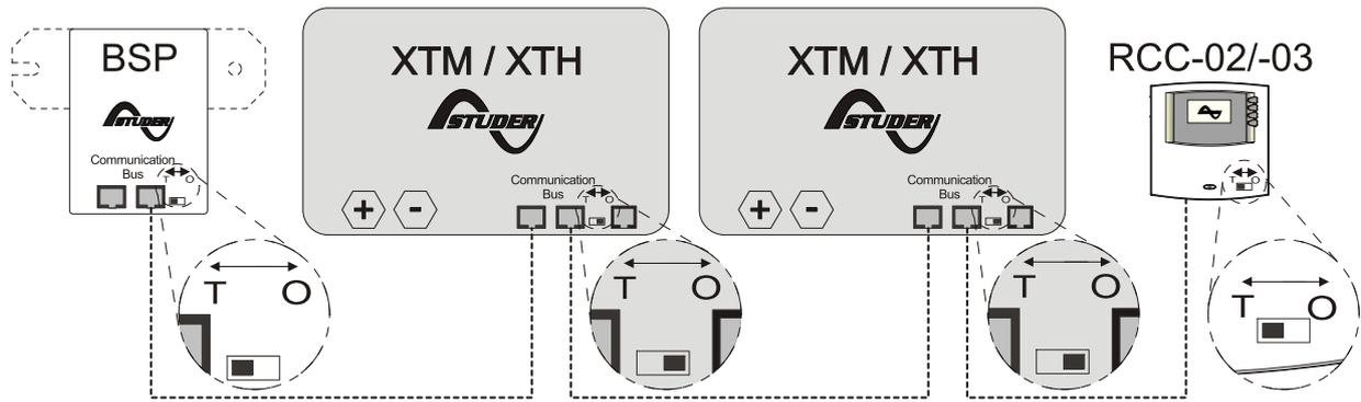
**Abbildung 4.2. Der Kommunikationsbus des Xtender Systems online.**
