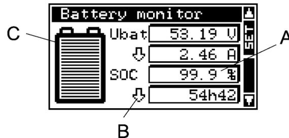
Abbildung 6.1. Ansicht des Batteriezustandes
