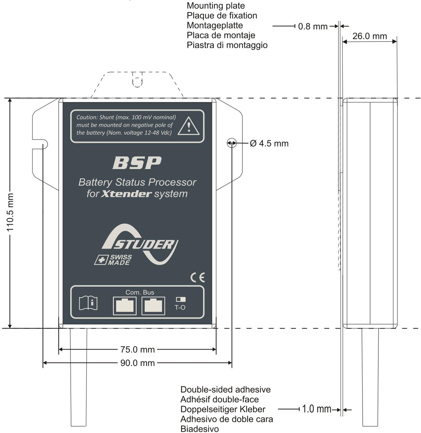
Abbildung 3.1. Ansichten der verschiedenen Seiten mit Abmessungen
