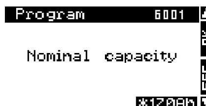
Ändern Sie den Wert um denjenigen Ihrer Batterie zu erhalten mit der Taste "Pfeil nach oben" oder "Pfeil nach unten". Bestätigen Sie mit der SET Taste die Einstellung.
