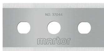
Die INDUSTRIEKLINGE NR. 37044 von MARTOR ist eine hochwertige Klinge aus Stahl. Sie ist sehr scharf und verfügt über vier nacheinander nutzbare Schneidkanten für eine besonders hohe Einsatzzeit. Der Breitschliff erleichtert das Schneiden. Die Klinge ist 43 mm lang, 22 mm breit und 0,40 mm stark.
