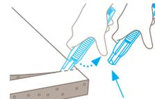
Der automatische Klinsenrückzug schützt Sie vor Schnittverletzungen. Voraussetzung: Nach dem Einstechen nehmen Sie den Daumen vom Schieber. Alternativ können Sie den Schieber und die Klinge auch arretieren. Wenn Sie die Arretierung lösen, zieht sich die Klinge wie gehabt zurück.
