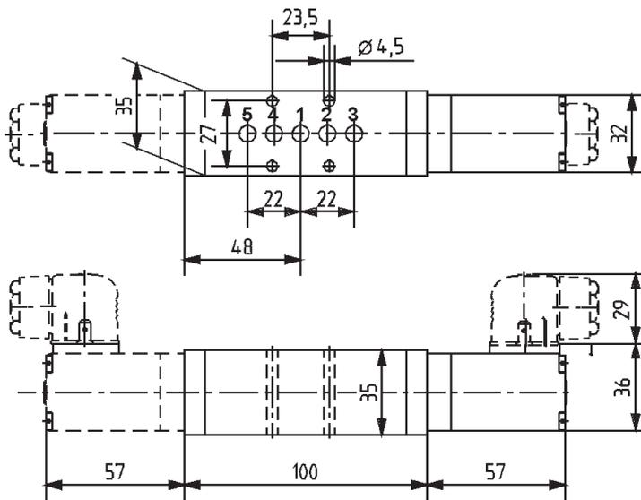
Ventile mit Namur-Flansch, Ventilbreite 25 mm, Leitungsanschluß G 1/4 für die Versorgungsanschlüsse 1, 3 und 5
