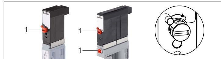
Bild 9: Manuelle Betätigung des Vorsteuerventils
