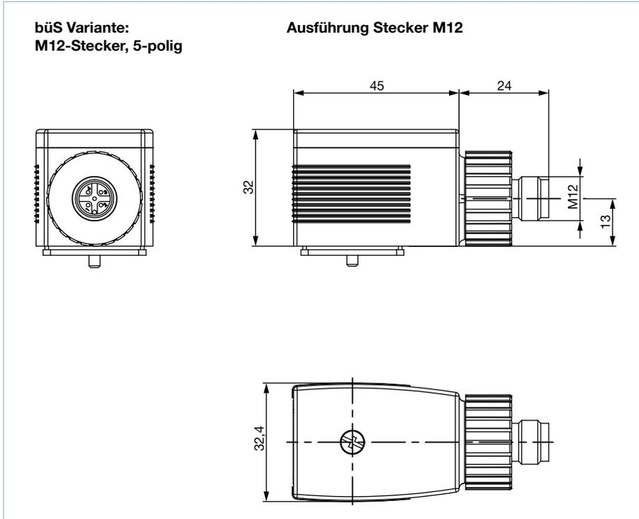
**Gerätesteckdose M12-Stecker, 5-polig und Sensoreingang M12-Buchse, 5-polig**
