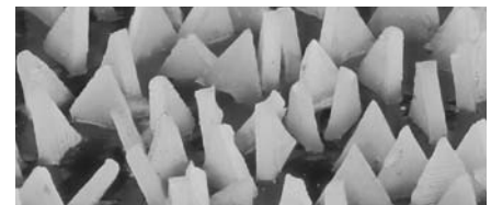
Optimale Ausrichtung des VICTOGRAIN-Schleifkorns
