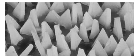
Optimale Ausrichtung des VICTOGRAIN -Schleifkorns
