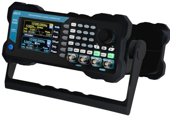
Der programmierbare Signalgenerator PSG9080 kann viele verschiedene Wellenformen wie z. B. Sinus-, Rechteck-, Dreieck-, Puls- und Benutzerdefinierte Wellen erzeugen. Der Signalgenerator hat einen großzügigen Frequenzbereich, der von 1nHz bis 80MHz reicht und eine Abtastrate von 300 MSa/s. Das Gehäuse ist hochwertig verarbeitet und bietet rutschfeste Standfüße, um ein angenehmes Arbeiten zu ermöglichen.
