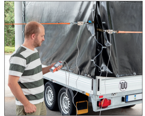
Messen von Kräften in verschiedenen Zug- oder Druckrichtungen mit nur einem Messgerät möglich
