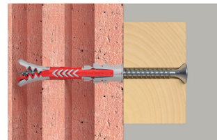
Langversionen mit zusätzlichem Biss in problematischen Baustoffen.
