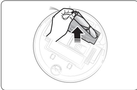
3 Heben Sie zuerst die linke Seite der Bürste an und ziehen Sie dann die Bürste aus der Nut auf der rechten Seite.
