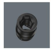
Das Sechskantprofil ermöglicht die Übertragung hoher Kräfte und belastet die Kanten der Schraubenmutter bzw. des Schraubenkopfes weniger als ein Zwölfkantprofil. Feinverzahnte Knarren machen darüber hinaus durch ihren kleinen Rückschwenkwinkel den Einsatz eines Zwölfkantprofils auch in Raumverhältnissen beengten überflüssig.
