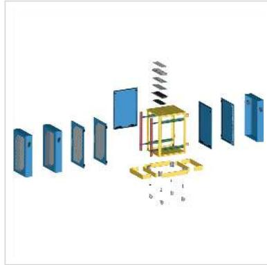
**Das VariIT 501 Gehäuse- und Schranksystem wurde entwickelt für den flexiblen Einsatz in Industrie- und Büroumgebungen. Es umfasst sowohl Wand- als auch kleinere Standverteiler.**
