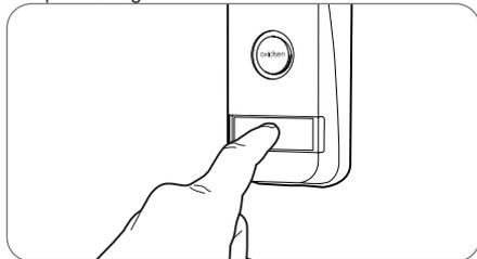
Die Klingel wird über den Lautsprecher des Monitors ausgelöst, der die Videokamera der Türsprechanlage aktiviert. Befindet sich der Besucher im Aufnahmebereich der Kamera, ist sein Bild 30 Sekunden lang auf dem Monitor zu sehen. Nach 30 Sekunden schaltet der Monitor wieder in den Stand-by-Modus.
