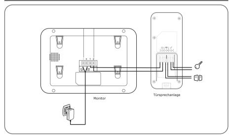
**WICHTIG:** schließen Sie die Klemmen 3 und 4 direkt an den Öffner-/Schließerkontakt der automatischen Steuerung an (drahtgebundener Steuereingang eines Torantriebs).
