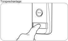
Die Klingel wird über den Lautsprecher des Monitors ausgelöst, der die Videokamera der Türsprechanlage aktiviert. Befindet sich der Besucher im Aufnahmefeld der Kamera, ist sein Bild 30 Sekunden lang auf dem Monitor zu sehen. Nach 30 Sekunden schaltet der Monitor wieder in den Stand-by-Modus.
