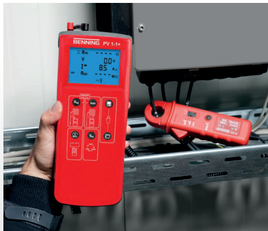
DC-Betriebsstrommessung mit BENNING CC 3
