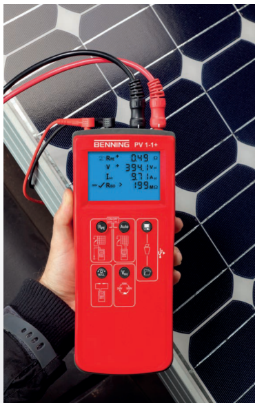
Automessung am PV-Strang (Uoc, Isc, Riso)
