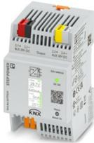
Primär getaktete Busspannungsversorgung, STEP POWER, Hebel-Push-in-Anschluss, Tragschienen- und Direktmontage, Eingang: 1-phasig, Ausgang: 30 V DC / 640 mA
