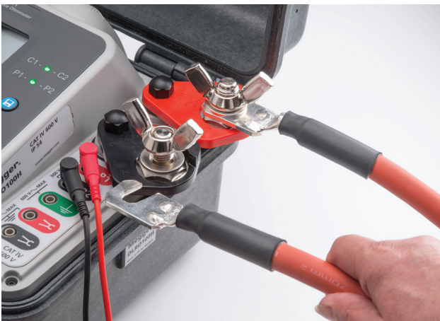
Es wurde ein neuer Anschlussadapter entwickelt, bei dem Nutzer ihre eigenen Messleitungen verwenden können.
