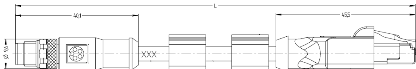
gerader M8x1-Stecker auf gerader RJ45-Stecker, geschirmt
