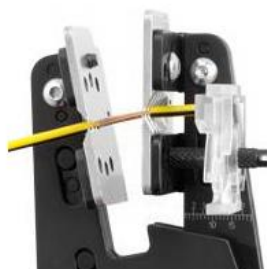
Abisolieren durch Formmesser
