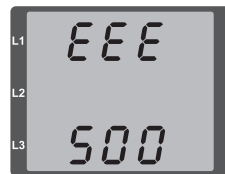
Abb. Fehler 500 (Netzfrequenz)
