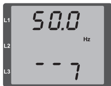
Abb. Anzeige der Netzfrequenz (50.0) und der Drehfeldrichtung
