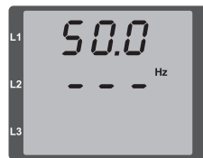
Abb. Keine Drehfeldrichtung feststellbar („---“).
