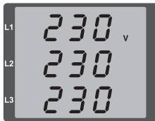
Abb. Beispielanzeige: Netzspannung je Phase
