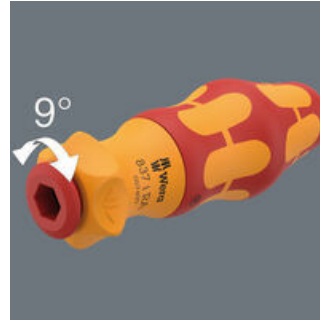
Die integrierte Ratsche mit Feinverzahnung (40 Zähne und ein Rückholwinkel von 9°) vereinfacht und beschleunigt das Schrauben ohne mühsames Neuansetzen.
