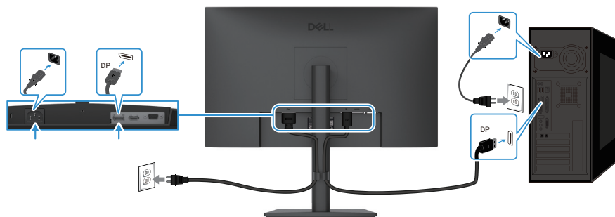
Abbildung 15. Anschließen des DP-Kabels
