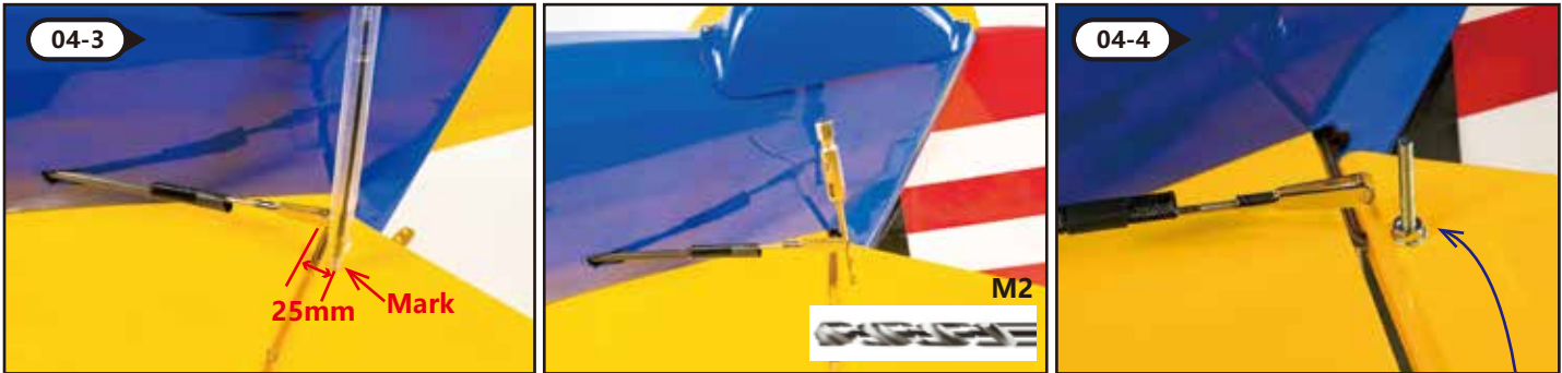
Anlenkgestänge für das Höhenruder bis zur Anlenkung in den Rumpf einführen.
