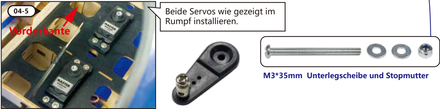
Anlenkgestänge für das Höhenruder bis zur Anlenkung in den Rumpf einführen.
