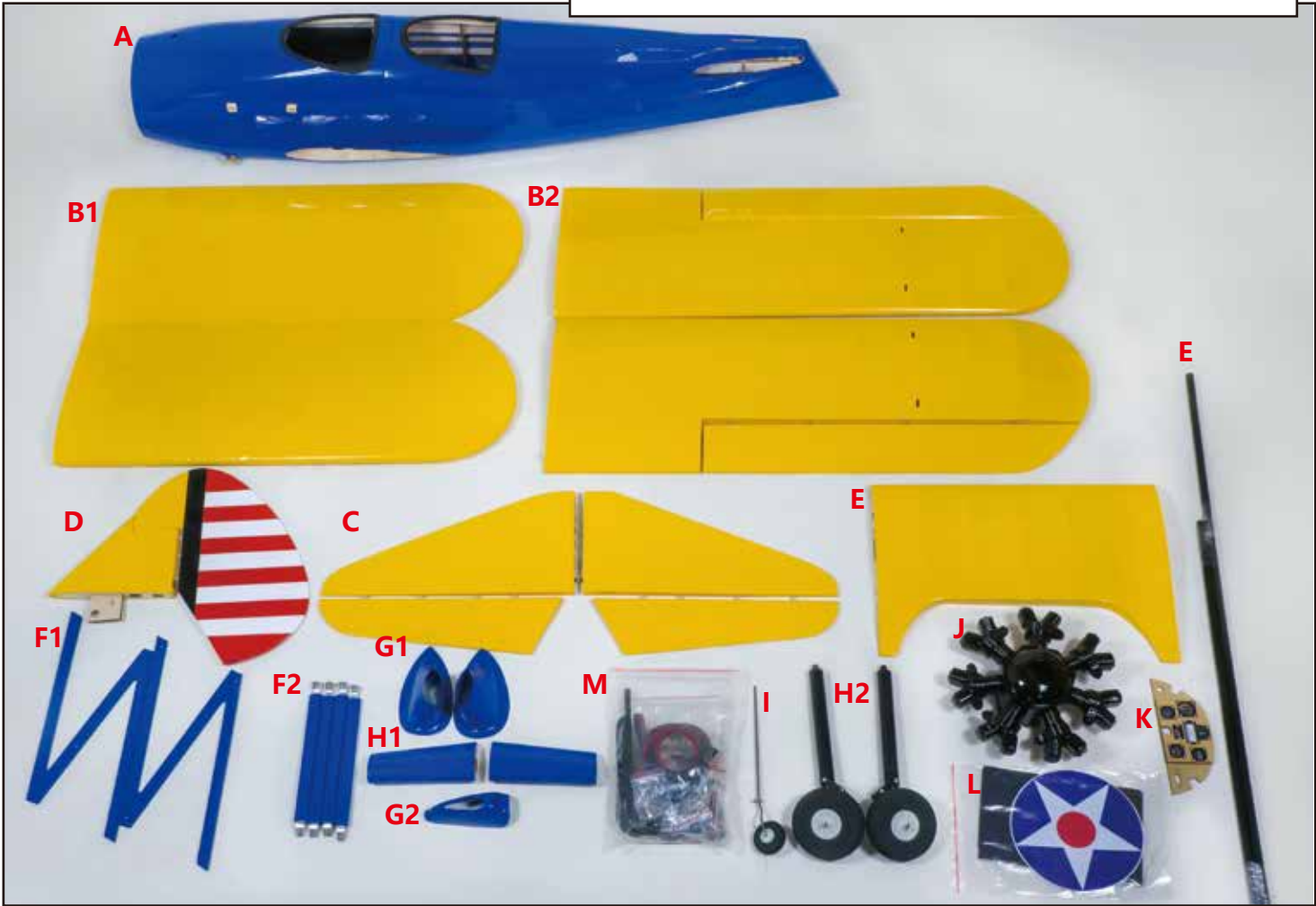
A: Rumpf B1-2: Tragflächen oben/unten C: Höhenruder D: Seitenruder E: Flächenverbinder F1-2: Halterungen G1: Fahrwerksverkleidung G2: Heckspornradverkleidung H1-2: Fahrwerk I: Heckspornrad J: Motorattrappe K: Armaturenbrett L: Dekor M: Kleinteile
