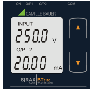
Anzeige 6: Spannungs- Eingang und Ausgang 2 als Strom
