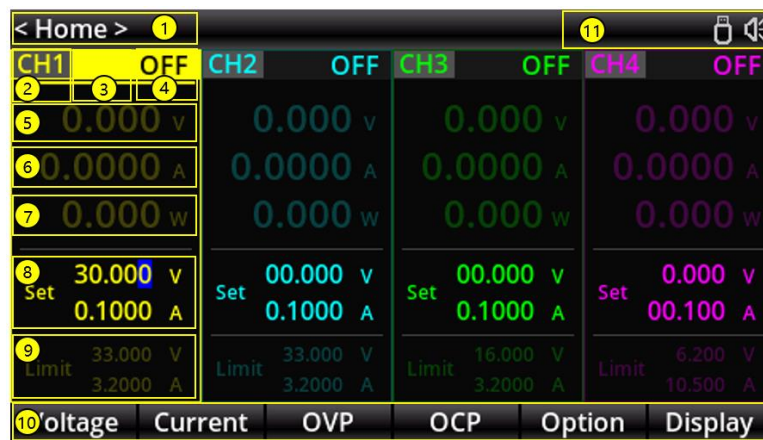
Abbildung 2-6 Benutzeroberfläche des UDP4303S
