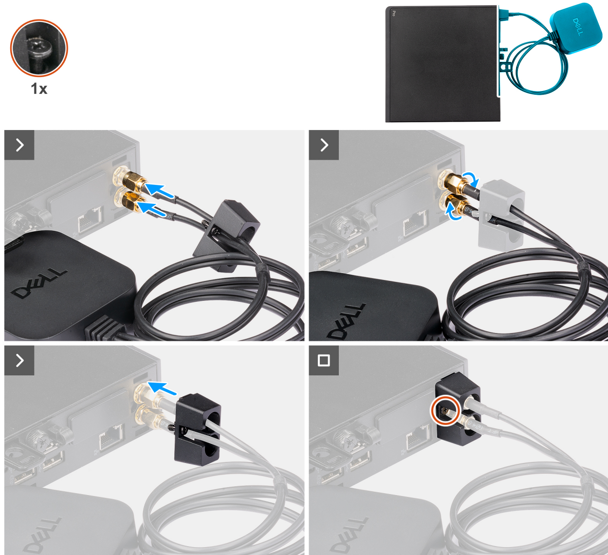
Abbildung 35. Einbauen der externen Puck-Antenne
