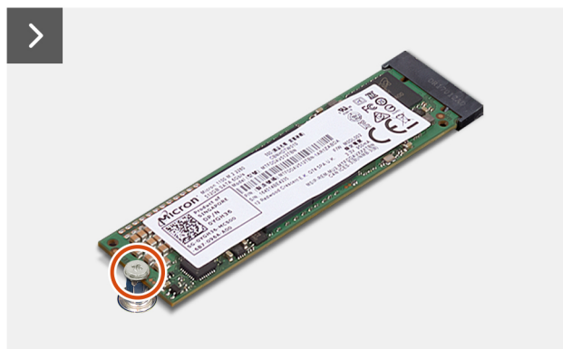
Abbildung 19. Entfernen des M.2-2280-Solid-State-Laufwerks
