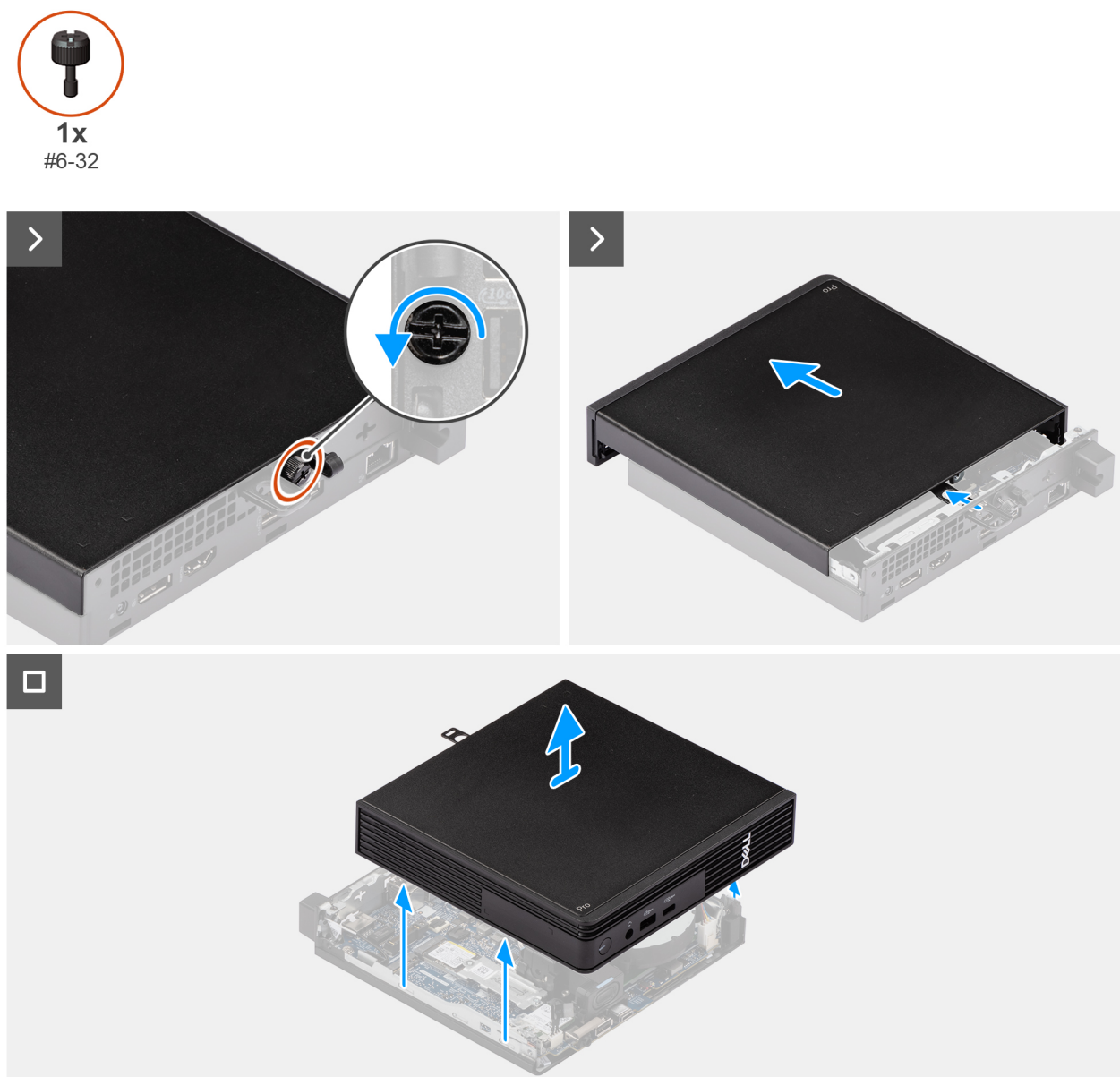
Abbildung 10. Entfernen der Seitenabdeckung
