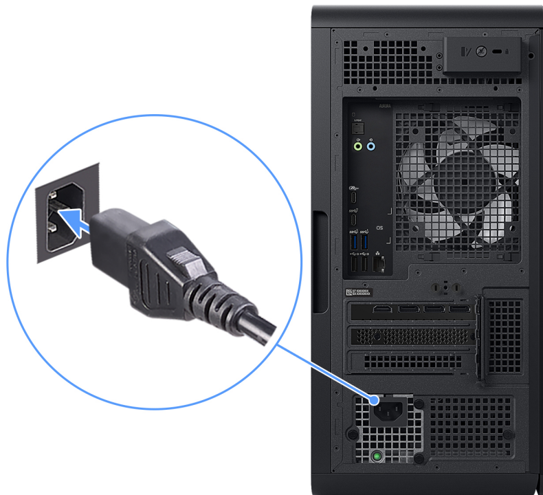
Abbildung 10. Anschließen des Stromkabels
