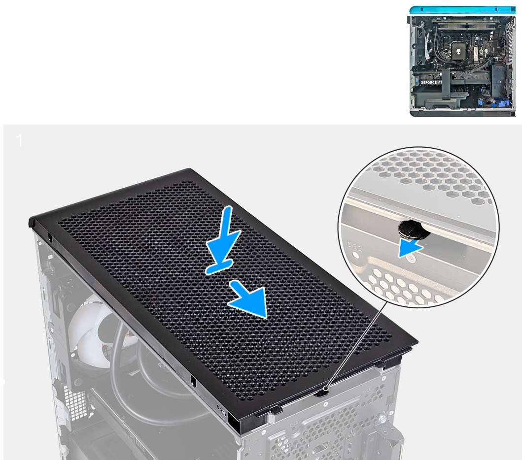
Abbildung 21. Anbringen der oberen Abdeckung
