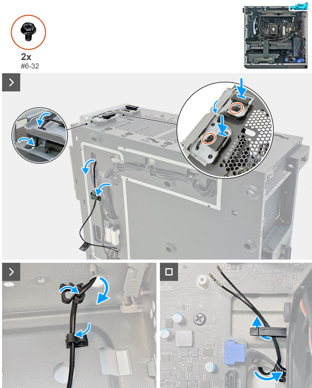
Abbildung 58. Einbauen der Antenne
