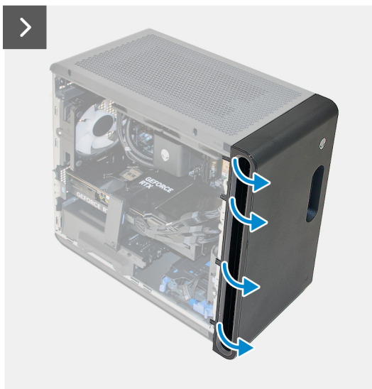
Abbildung 18. Entfernen der Frontverkleidung
