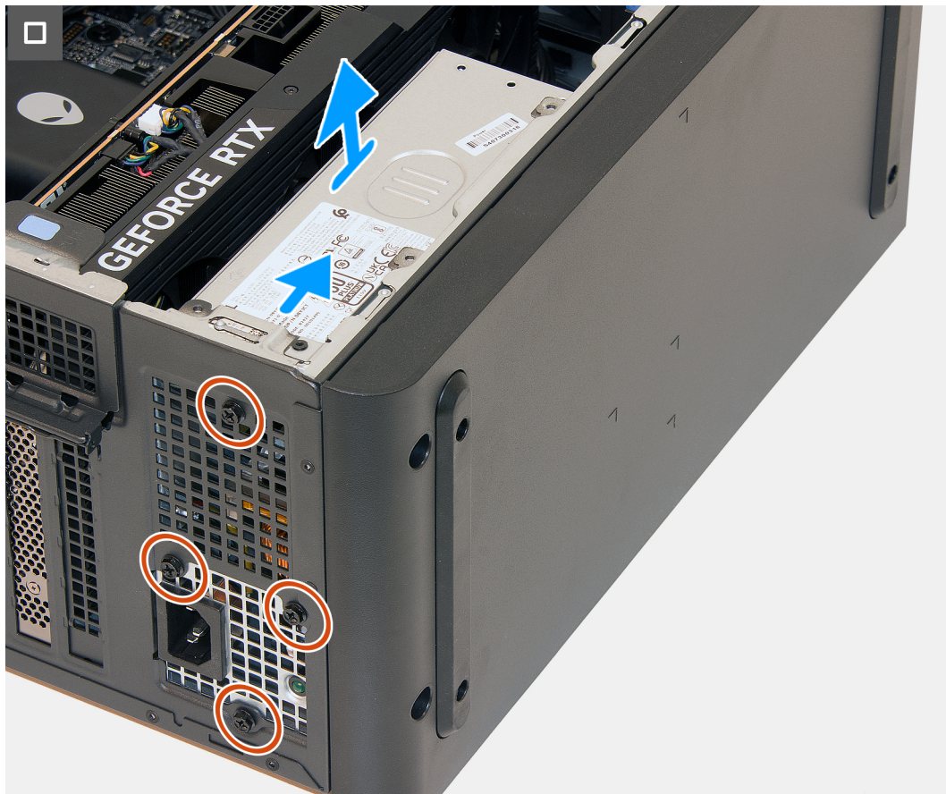
Abbildung 46. Entfernen der Stromversorgungseinheit
