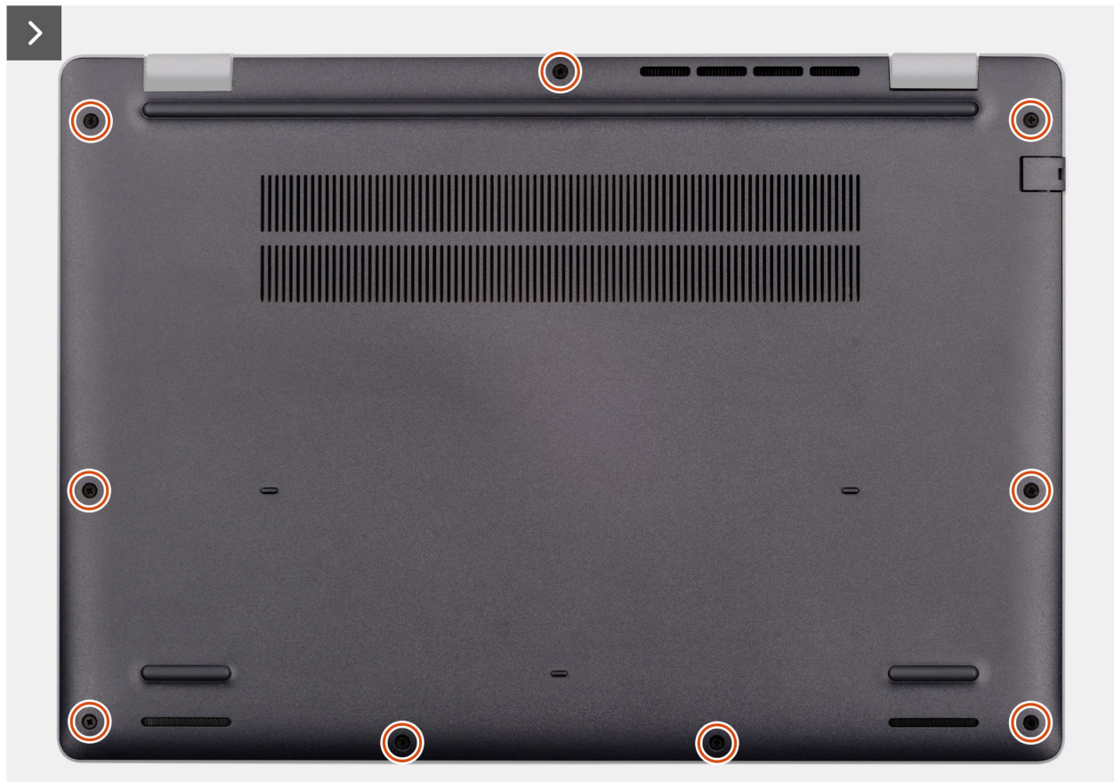
Abbildung 11. Entfernen der Bodenabdeckung
