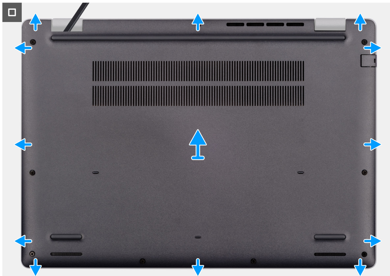
Abbildung 12. Entfernen der Bodenabdeckung
