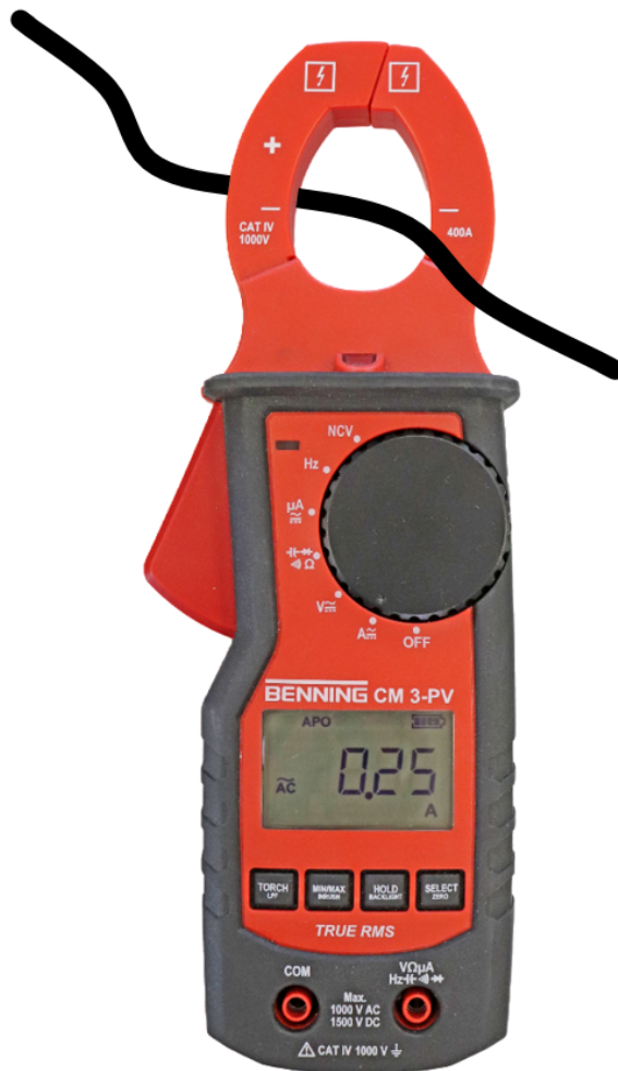
Abb. 10: Strommessung über Messzange (A)
