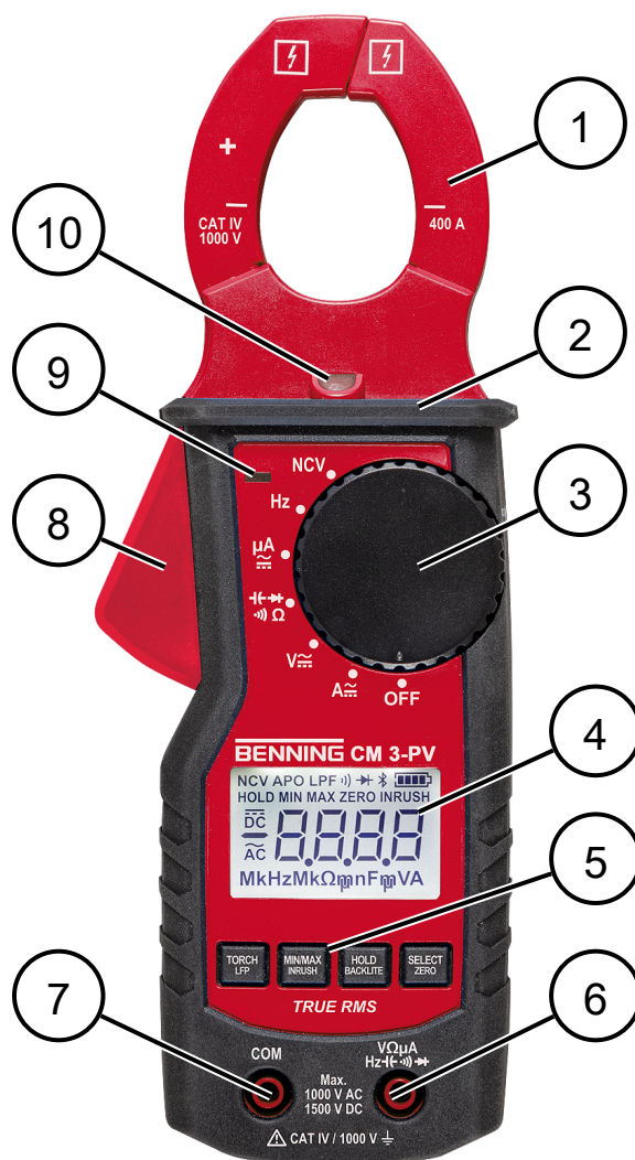
Abb. 6: Geräteaufbau BENNING CM 3-PV
