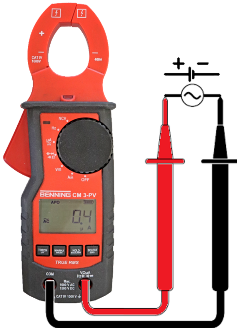
Abb. 11: Strommessung über Sicherheitsmessleitungen ( \mu\text{A} )
