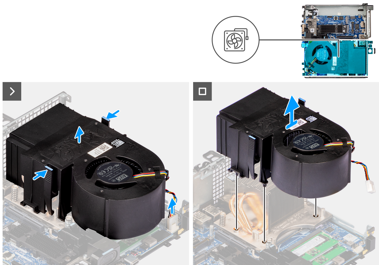
Abbildung 16. Entfernen des Systemlüfters
