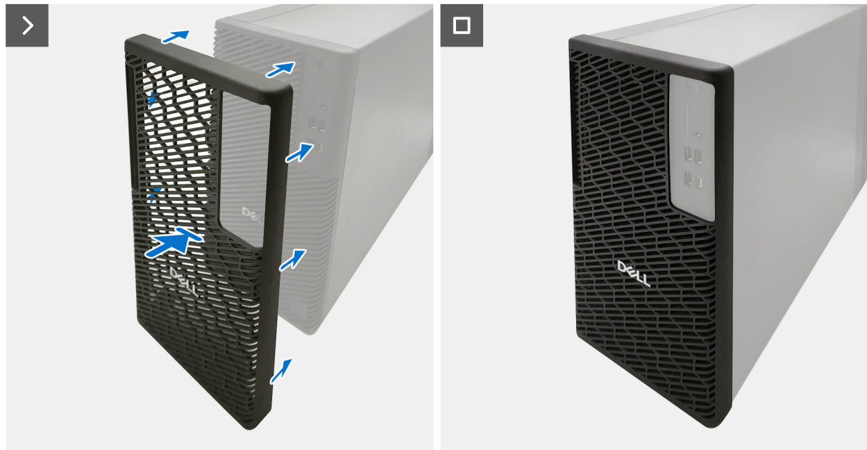
Abbildung 22. Installieren des Staubfilters
