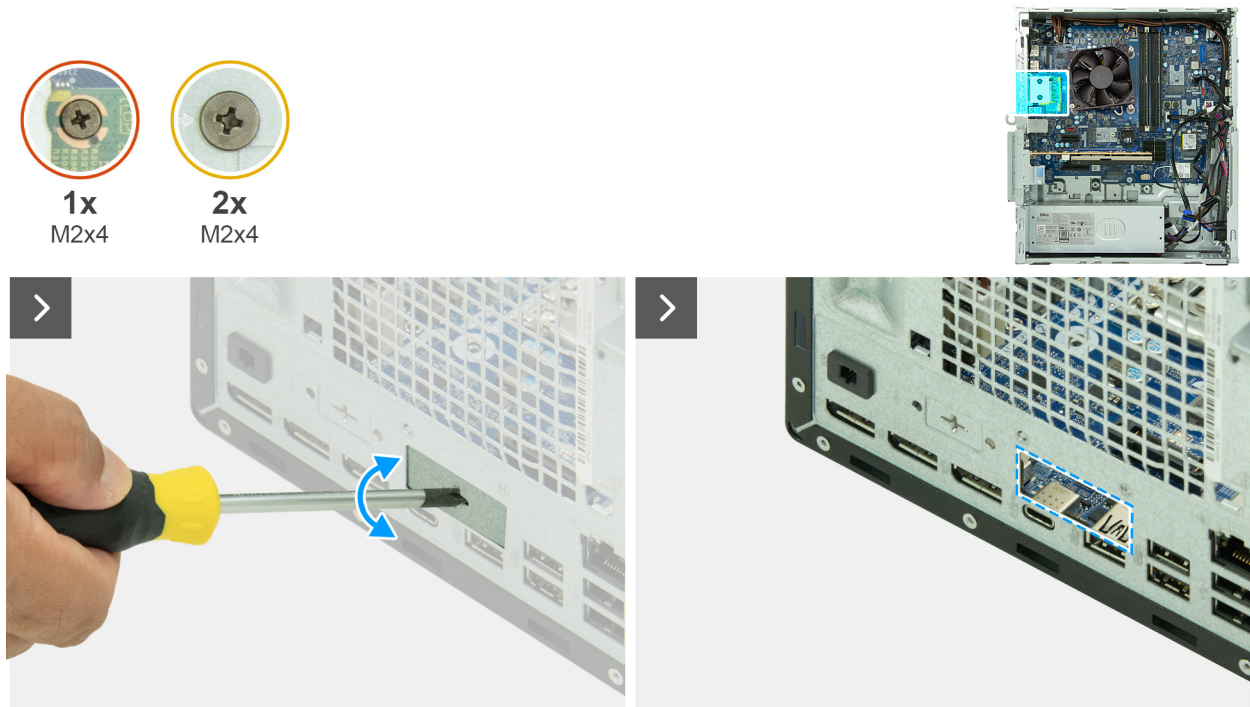
Abbildung 79. Installieren des Fiberoptik-Port-Moduls
