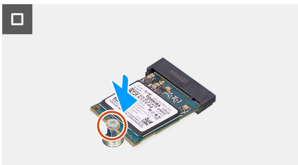
Abbildung 30. Installieren des M.2 2230-Solid-State-Laufwerks in Steckplatz 0
