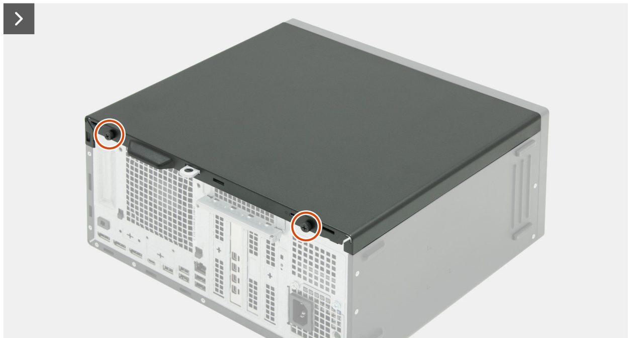
Abbildung 13. Entfernen der linken Abdeckung
