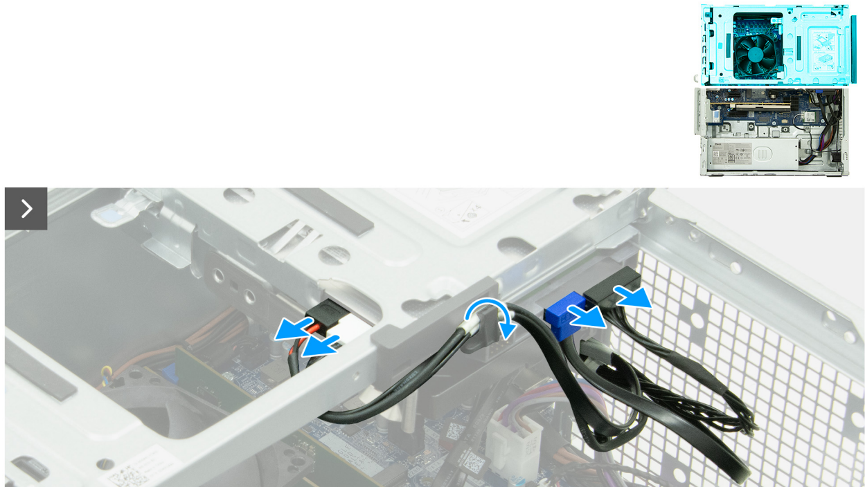
Abbildung 58. Entfernen des Laufwerksschachts
