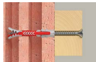
Langversionen mit zusätzlichem Biss in problematischen Baustoffen.
