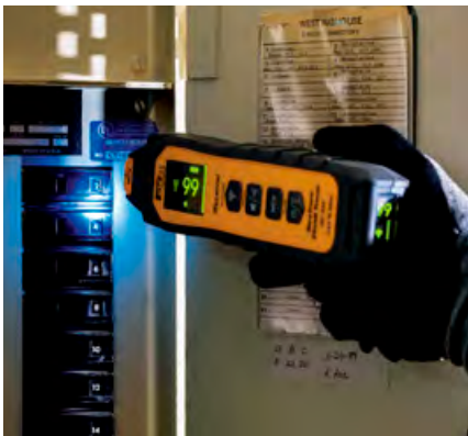
Im Sicherungs-Modus erkennt der Empfänger den Stromkreis, an den der Sender angeschlossen ist.
