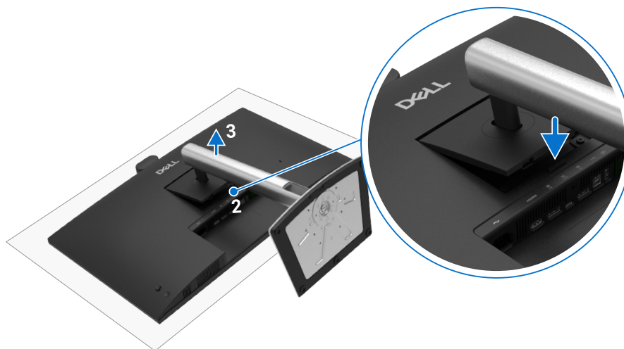
Abbildung 60. Entfernen des Monitorständers
