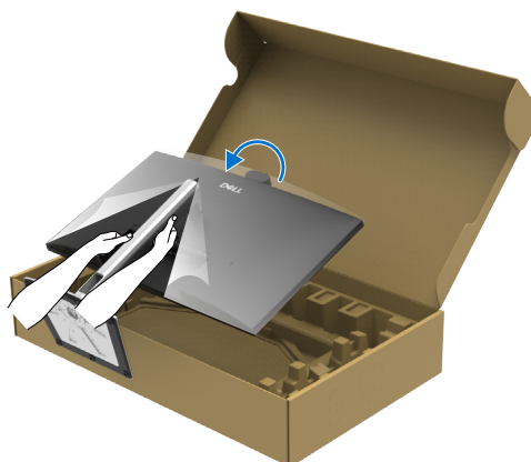
Abbildung 23. Halten Sie den Ständer und heben Sie den Monitor an
