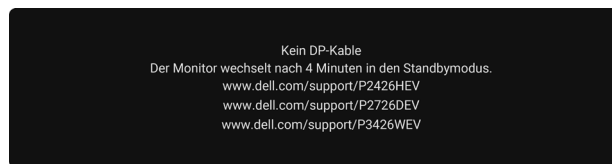
Abbildung 96. Warnmeldung: DP-Kabel nicht angeschlossen
