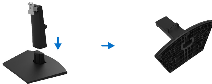
Abbildung 10. Montieren des Ständers
