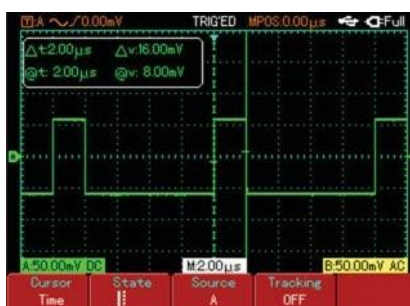
Abbildung 3-6 Messung der Impulsbreite mit den Cursorsn
