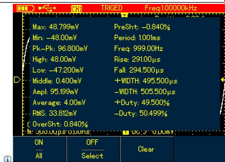
Abbildung 6-16A UTD1000CL misst alle Parameter
