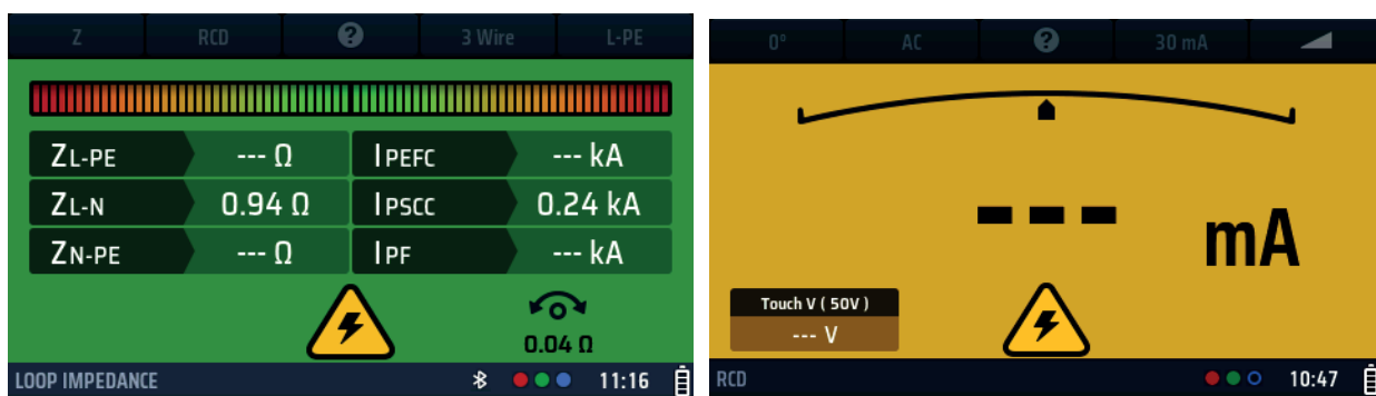
Abb. 32: Warnung bei spannungsführender Prüfung – Beispiele für Schleifenprüfungen und FI-Prüfungen
