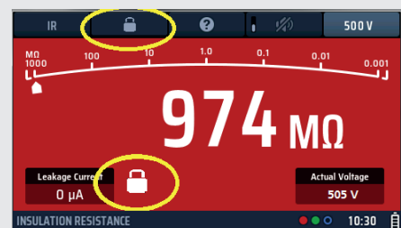
Abb. 23: Dauerhafte Fixierung der Isolationsprüfung
