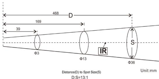
Je weiter das Messgerät von der zu messenden Oberfläche entfernt ist, umso mehr wird gemessen. Wenn der Messfleck zu groß ist, kann es passieren, dass ungewünschte Messflächen mitgemessen werden. Dadurch erhalten Sie falsche Messwerte.
