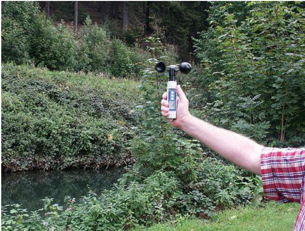
Eine Windmessung mit dem Schalenkreuz-Anemometer PCE-A 420
