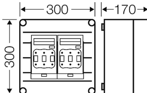
**NH-Sicherungslast-trennschaltergehäuse auf Sammelschienen**
