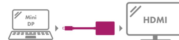
Der Adapter verbindet ein Notebook/Tablet/PC zu einem Monitor/Beamer/TV mit bis zu 1920x1200@60 Hz. (Die max. Auflösung ist abhängig vom verwendeten Monitor)
