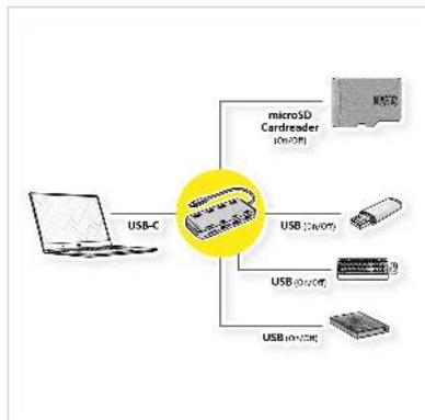
**3-Port USB 3.2 Gen 1 Hub mit USB Typ C Anschlusskabel - zum Verbinden von bis zu drei Peripherie- oder Speichergeräten an ein Tablet (z.B. Apple iPad Pro), Ultrabook, Notebook/Laptop oder PC mittels USB Typ C. Mit Card Reader zum Anschluss einer Micro SD Karte. Zusätzlich lassen sich die einzelnen Ports individuell ab- und zuschalten.**
